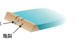
②破損した堤防が、貯水に耐え切れず「決壊」
